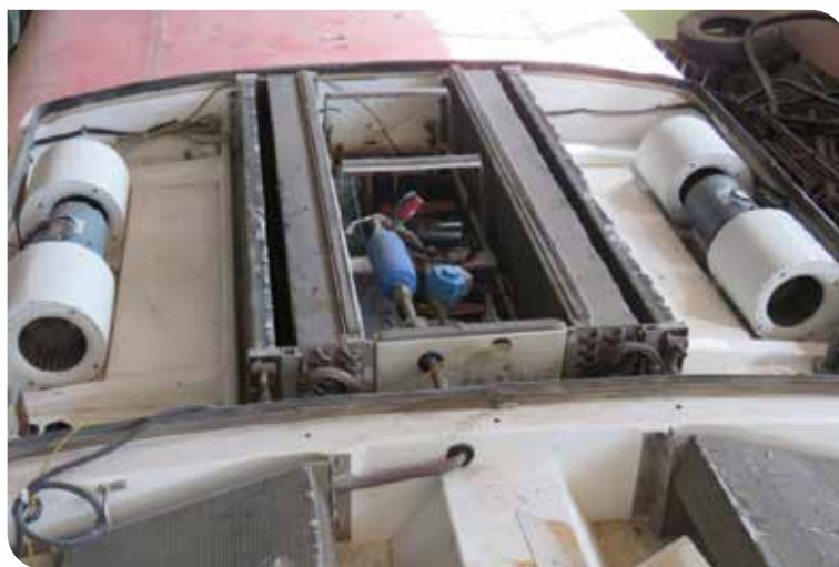
تجهیز اتوبوس بنز ۰۴۵۷ فاقد کولر به سیستم سرمایشی
