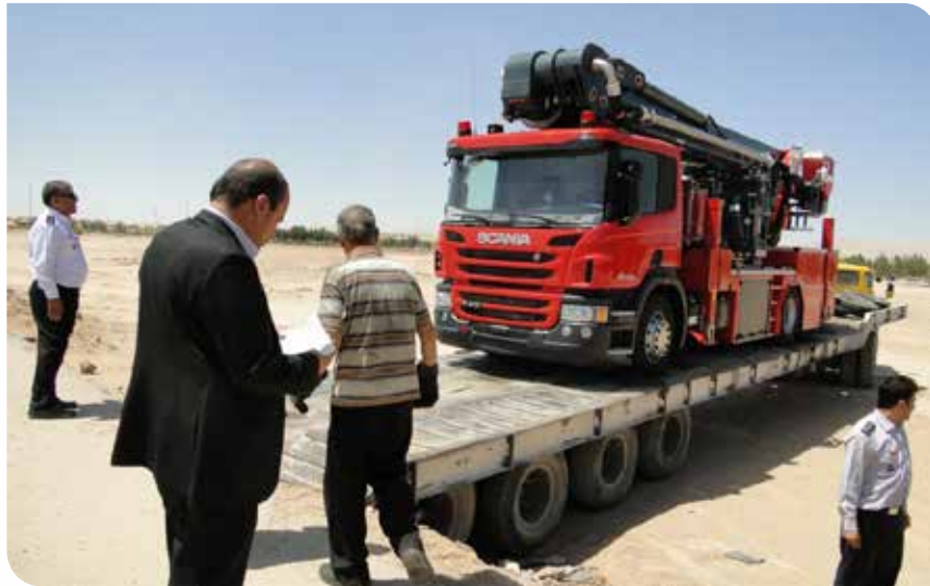
تحويل يك دستگاه بالابراآتش نشانی و امداد و نجات هیدرولیکی با ارتفاع کاری ۳۲ متر
